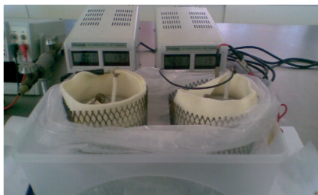
Figura 1. Prototipos y mallas de titanio conectadas a la fuente de poder para efectuar la EEC
