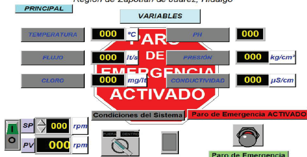
Figura 7. Interfaz gráfica de MONITOREO en modo de edición. La pantalla MONITOREO muestra la medición en tiempo real de todas las variables.
