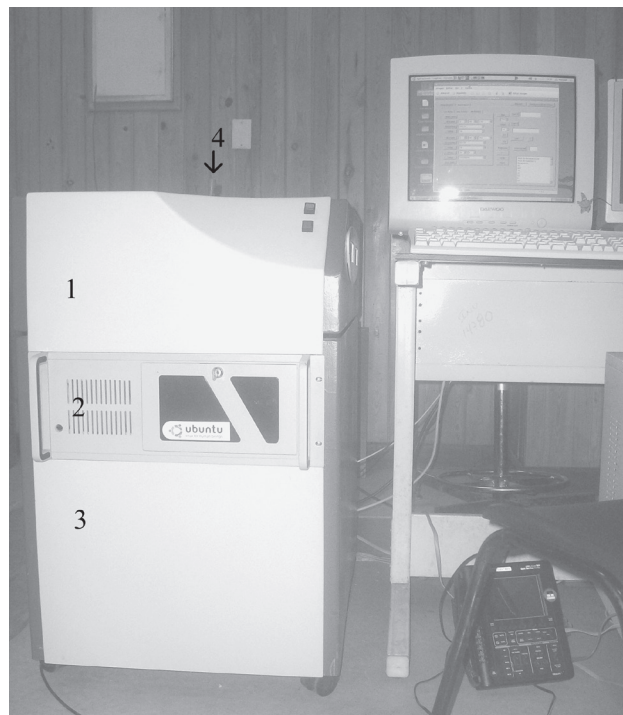
Figura 2. Vista general del equipo experimental de relaxometría. 1) sección electromagnética, 2) PC, 3) sección de electrónica analógica, 4) entrada del tubo porta-muestras
