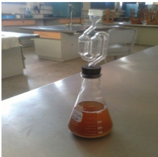
Figura 1. Fermentador acondicionado para producción de cerveza artesanal
