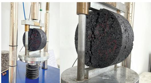
Figura 10. Ensayo de agrietamiento por tensión indirecta (IDEAL-CT, ASTM D8225-19), (ASTM, 2019)
