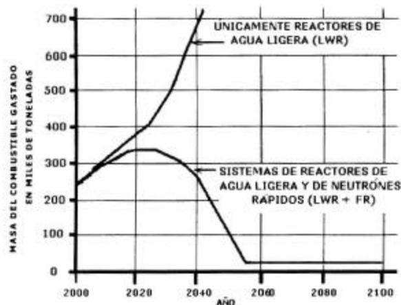
Figura 12. Decremento del combustible nuclear gastado, almacenado en el mundo al integrar sistemas de reactores rápidos y de agua ligera, proyección al 2100 (Adaptado de DOE, 2002)
