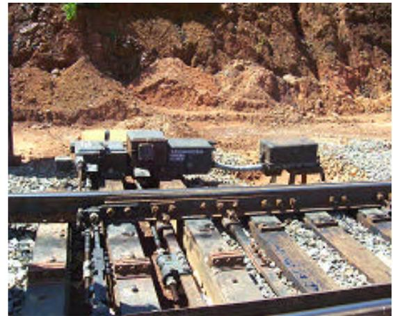
Figura 4. Aparato de cambio para vía de escape
