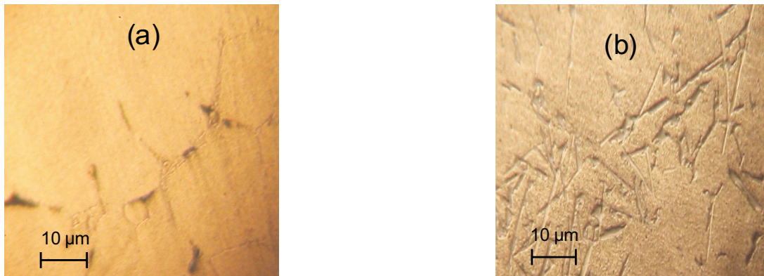
Figura 3. Fotomicrografía de la chatarra fundida (a) y de la aleación Al-Si (b)
