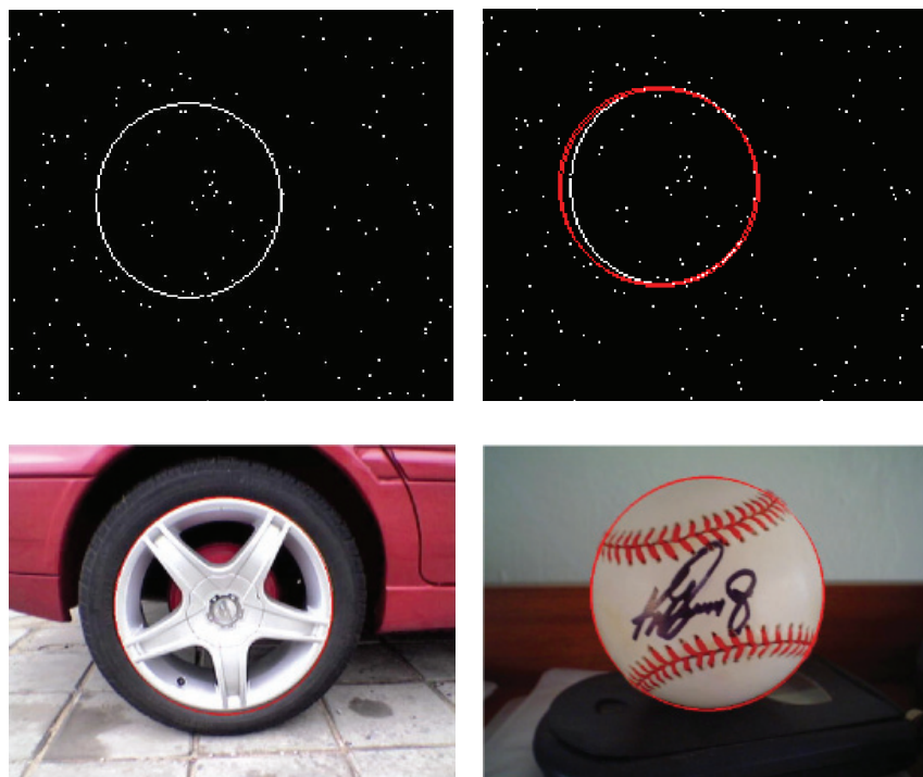
Figura 6. Detección de círculos en imágenes sintéticas: a) imagen de círculo original con ruido, b) círculo detectado
