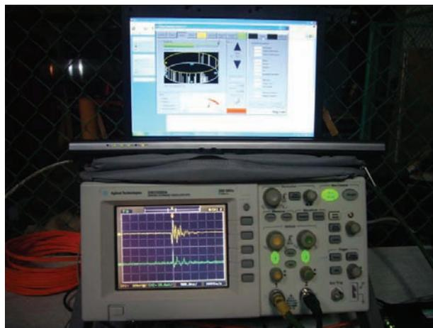
Figura 8. Detección eléctrica y acústica de DP
