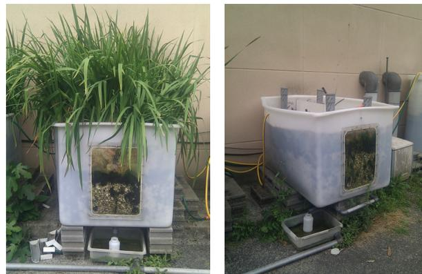
Figura 1. Humedales experimentales. Izda.: HFV2. Dcha.: HFV4 lecho sin vegetación
