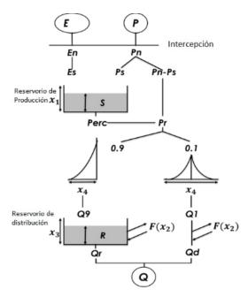
Figura 3. Diagrama del modelo hidrológico GR4J
