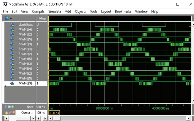
Figura 6. Señales PWM obtenidas mediante simulación en ModelSim
