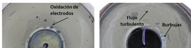
Figura 3. Oxidación de electrodos, flujo turbulento y burbujas
