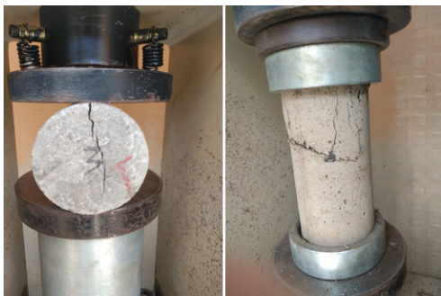
Figura 6. Ensayo de resistencia a la tensión y compresión Fuente: Elaboración propia
