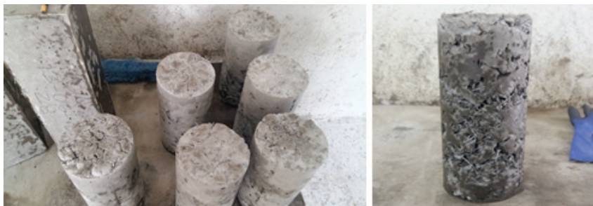
Figura 4. Especímenes de concreto reforzado con 1.00 % y 1.50 % de fibras
