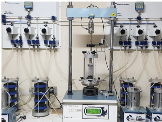
Figura 12. Ensamble final de la probeta en el equipo triaxial
