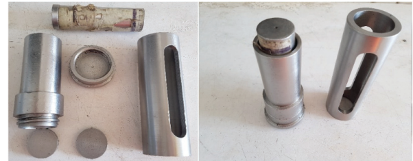
Figura 11. Molde de compactación para la elaboración de los especímenes utilizados en el ensaye triaxial
