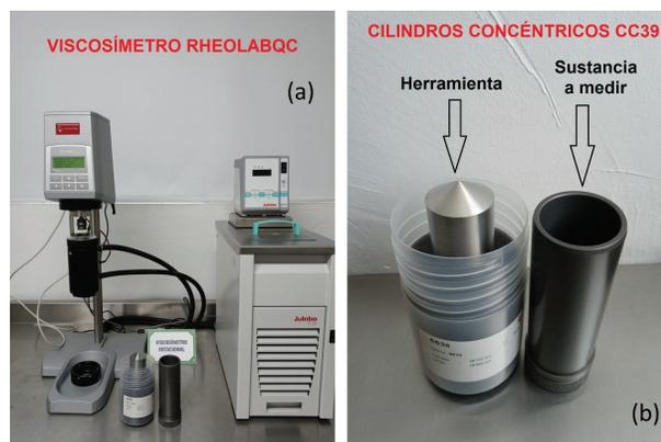
Figura 2. a) Viscosímetro rotacional RheolabQC y b) herramienta de cilindros concéntricos CC39
