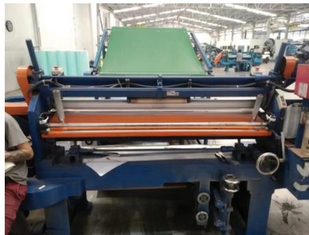
Figura 3. Rodillo instalado en la máquina de división de rollos de EVA
