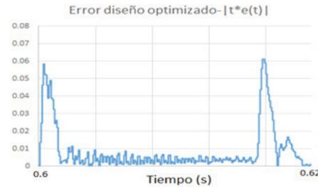
Figura 11. Curva de error resultante para el vector  $i_{g,d}$  en el intervalo 0.6s – 0.62s
