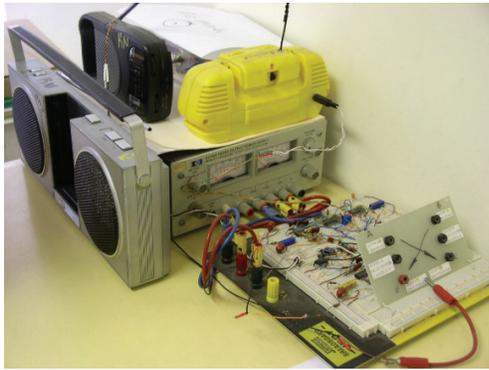
Figura 4. Maqueta de comunicación encriptada en operación que utiliza “dos circuitos de Lorentz” como osciladores caóticos (Núñez, 2006a)
