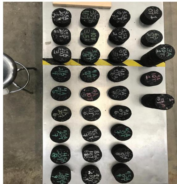
Figura 4. Especímenes compactados de mezcla asfáltica con los diferentes contenidos de asfalto propuestos
