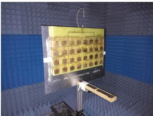
Figura 9. Arreglo plano de 32 elementos
