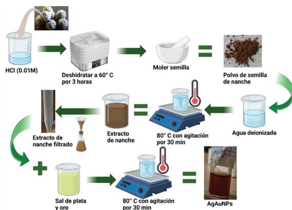
Figura 1. Metodología para la fabricación de las nanopartículas
