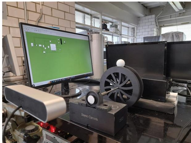
Figura 8. Aplicación con el sistema embebido para el sistema rueda-bola en tiempo real
