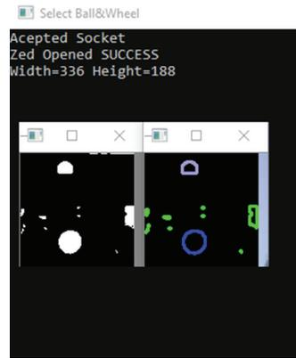
Figura 10. Adquisición de datos mediante el procesamiento de imágenes de la bola mediante la cámara ZED en tiempo real
