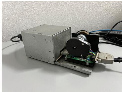
Figura 3. Servomecanismo integrado con la tarjeta embebida
