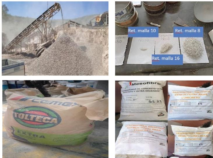
Figura 1. Materiales utilizados en la elaboración de las diferentes mezclas: a) Grava basáltica, b) PET triturado en hojuelas, c) Cemento y d) Macrofibras sintéticas
