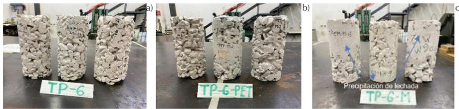
Figura 2. Distribución de pasta cementante en las diferentes mezclas: a) Mezcla TP-6, b) Mezcla TP-6-PET, c) Mezcla TP-6-M
