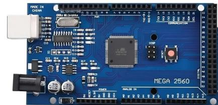
Figura 4. Tarjeta de desarrollo genérica basada en la Arduino mega 2560, (RANTEC ELECTRONICS, 2022).
