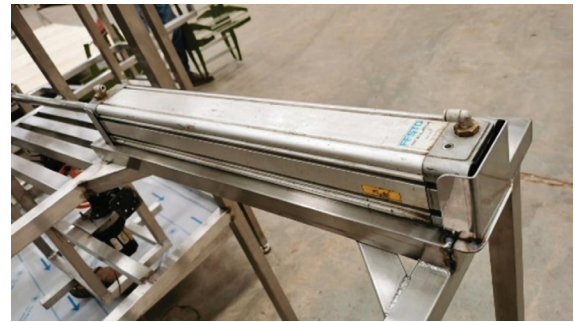
Figura 6. Pistón principal que sirve para iniciar secuencia de botellas
